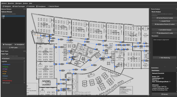
Figuur 3. De zelfontwikkelde graaf-software, met daarop zichtbaar de geïmporteerde plattegrond en de geplaatste knooppunten en verbindingen voor een segment van de begane grond.
