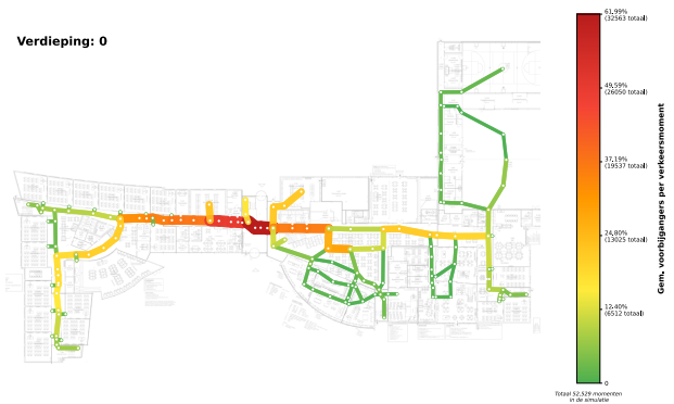
Figuur 8. Kans op het passeren van een edge op de begane grond, uitvergroot in figuur 14.
